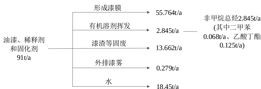
图 4-1 项目油漆物料平衡图
